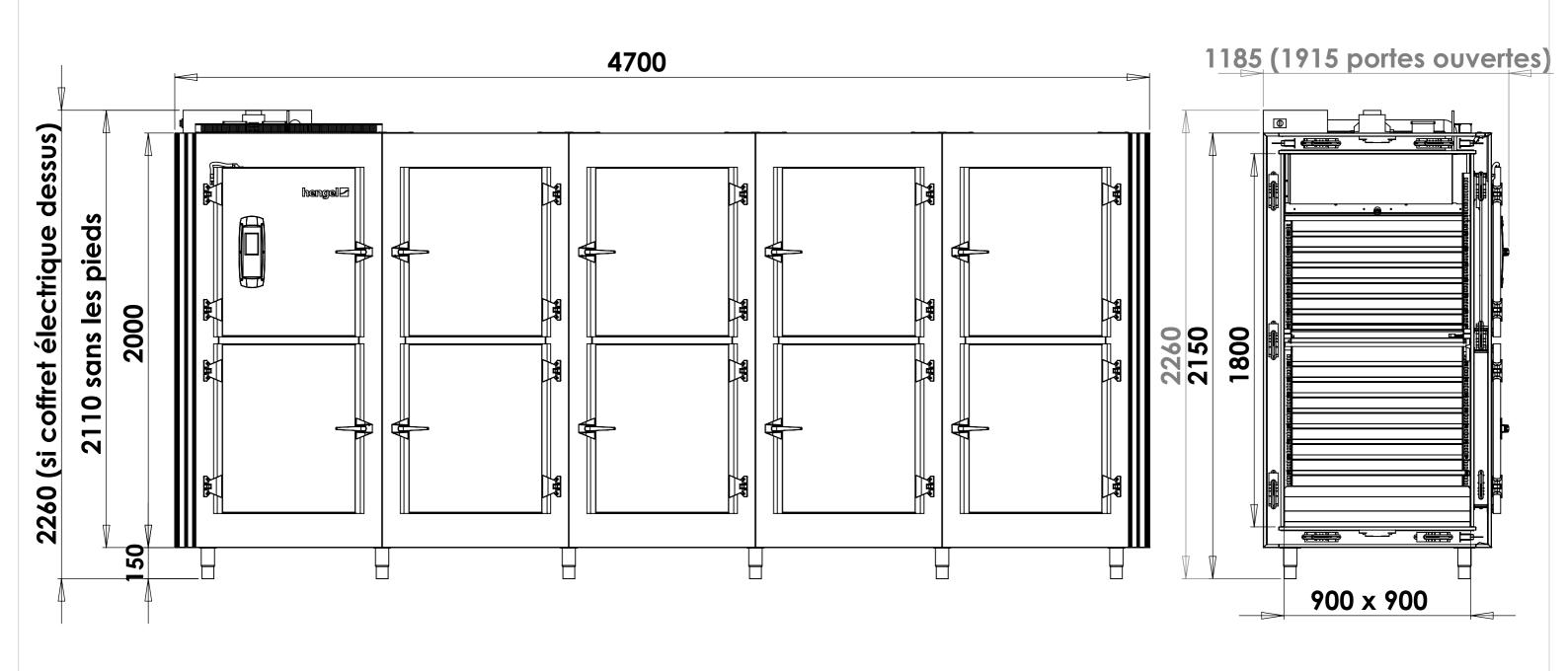
Voltage/ Voltage : 400V TRI + N + T / 50Hz Puissance / Puissance : 7.35KW
