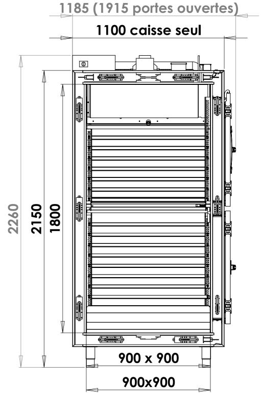
Voltage / Voltage : 400V TRI + N + T / 50Hz Puissance / : 6.95KW
