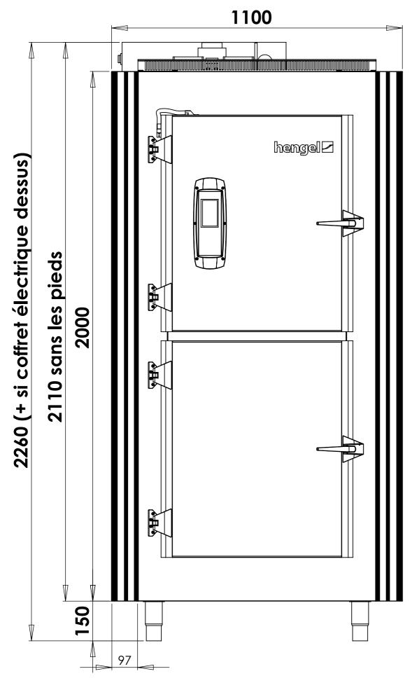
Voltage / Voltage : 400V TRI + N + T / 50Hz Puissance / Power : 6.95KW
