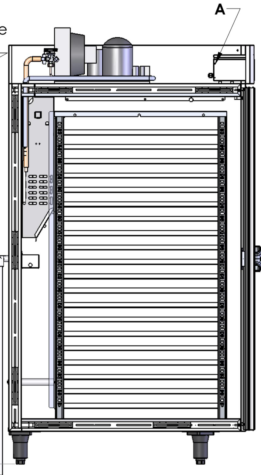
A - raccordement électrique
