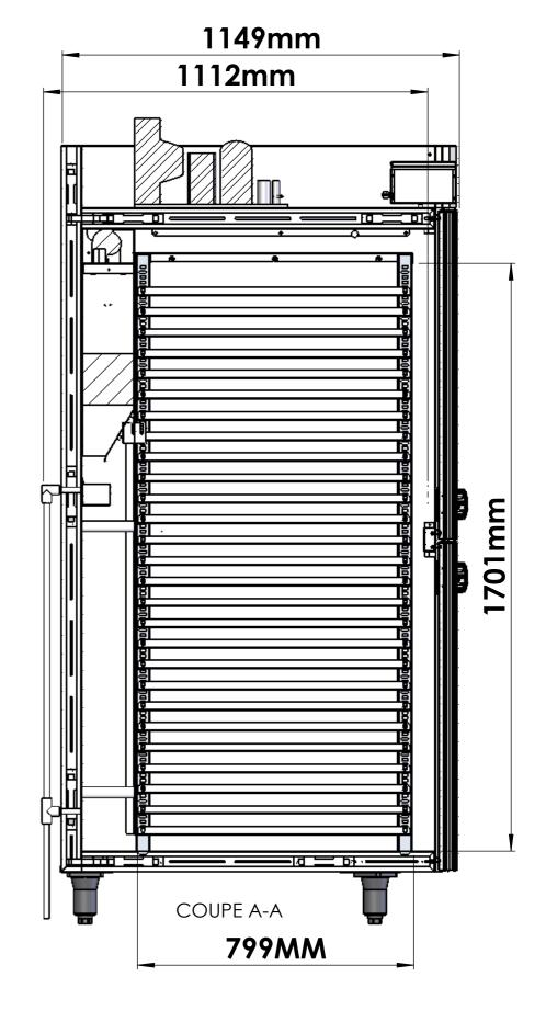
Puissance / Power: 1550W Voltage / Voltage: 230V 1 PH 50HZ Poids net / Weight: 180KG Position groupe / Position of refrigeration unit: en haut / on the top
