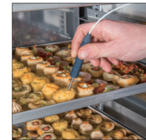
冷却または冷凍される製品の中心に芯温センサーをセット
